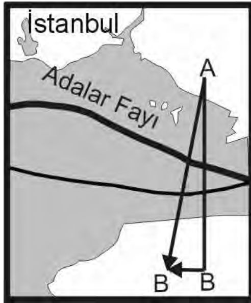
Şekil 1 Adalar Fayı üzerinde biriken gerilme AB: İki blok herhangi iki nokta arasında alınan uzaklık (dik kenar) BB': İki blok arasında sağ yanal ötelenme miktarı (kısa dik kenar) AB': Ötelenme sonrasında iki blok arasındaki oluşan yeni uzaklık (hipotenüs)
